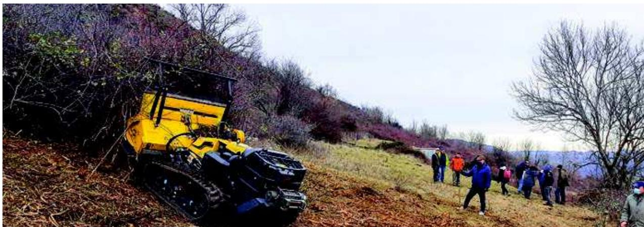
Nettoyage d'un terrain très embroussaillé au moyen d'un tracteur débroussaillieur télécommandé
